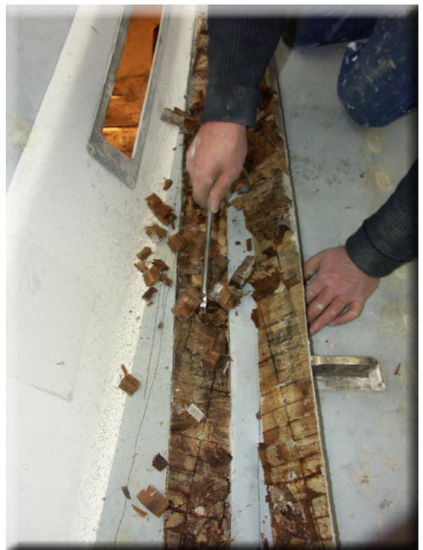
Nachgebender Deckaufbau lässt auf Beschädigungen im Laminat schließen und dieses Ausmaß wird nach dem Öffnen erkennbar
