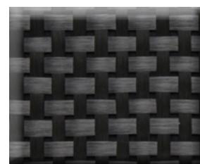
**Aramidfasern** zeichnen sich durch eine hohe Zähigkeit sowie einer besonders guten Schlag- und Abriebfestigkeit aus. Weitere Eigenschaften sind ein gutes Dämpfungsvermögen, eine hervorragende chemische Beständigkeit und die Nichtentflammbarkeit. Das Bearbeiten des Rohgewebes und der Lamine ist oftmals sehr schwierig und daher nur mit Spezialwerkzeug durchführbar.
