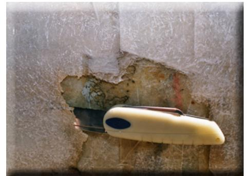
Massive Schädigung inkl. Delamination, Bereich muss mit Glasfasergewebe oder Gelegen neu aufgebaut werden
