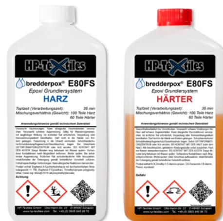
Sobald die Oberfläche angeleiert ist, kann die Folgeschicht Epoxidharz aufgetragen werden. Wird die Folgeschicht nicht innerhalb von 24 Stunden bei 20°C aufgebracht, muss die gesamte Oberfläche zwingend angeschliffen werden. Für Verklebungen oder Laminierarbeiten ungeeignete Untergründe sind z. B. PE, PP, weich-PVC, PTFE sowie einige weitere Spezialkunststoffe. Im Zweifel empfehlen wir Vorversuche.
