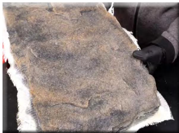
Überstehendes Gelege oder Gewebe kann mit einem Cuttermesser einfach entfernt werden.
