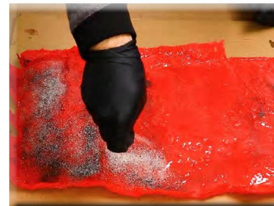
Trockener Sand wird in gewünschter Farbe und Körnung direkt auf dem flüssigen Gemisch verteilt.
