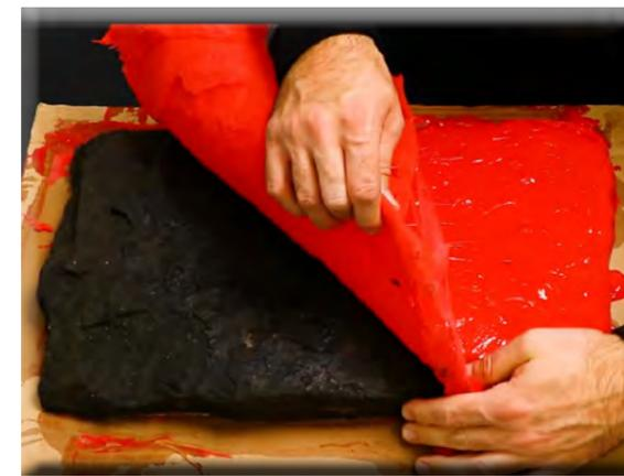
Nach circa 5 Stunden bei 20°C kann das ausgehärtete Silicon entformt werden.
