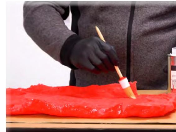
Nach der Entformung und vollständigen Durchtrocknung des Silicons wird das Trennmittel auf die Siliconform aufgetragen. Dabei muss die Trocknungszeit von circa 15 Minuten bei 20°C beachtet werden.
