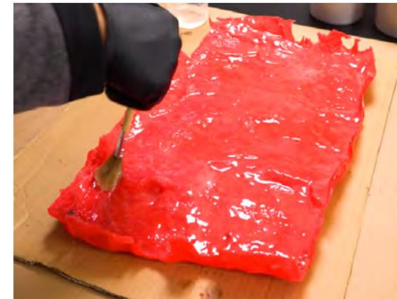
Nach vollständiger Trocknung des Trennmittels wird das passende Epoxidharz angemischt, auf die Siliconform aufgetragen und mit einem Pinsel gleichmäßig verteilt.
