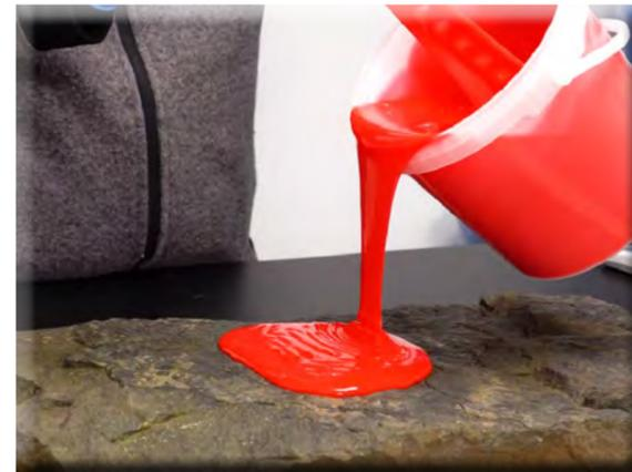
Durch Zugabe eines Thixotropiermittels für Silicon wird die Masse zähflüssiger, wodurch die Verlaufseigenschaften optimiert werden. Zudem verkürzt sich dadurch die Verarbeitungszeit.
