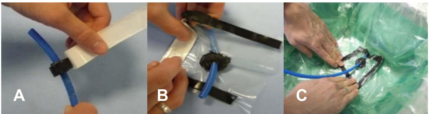
Abb. 17, A-C: Anschluss der Leitung zur Harzinfusion.
