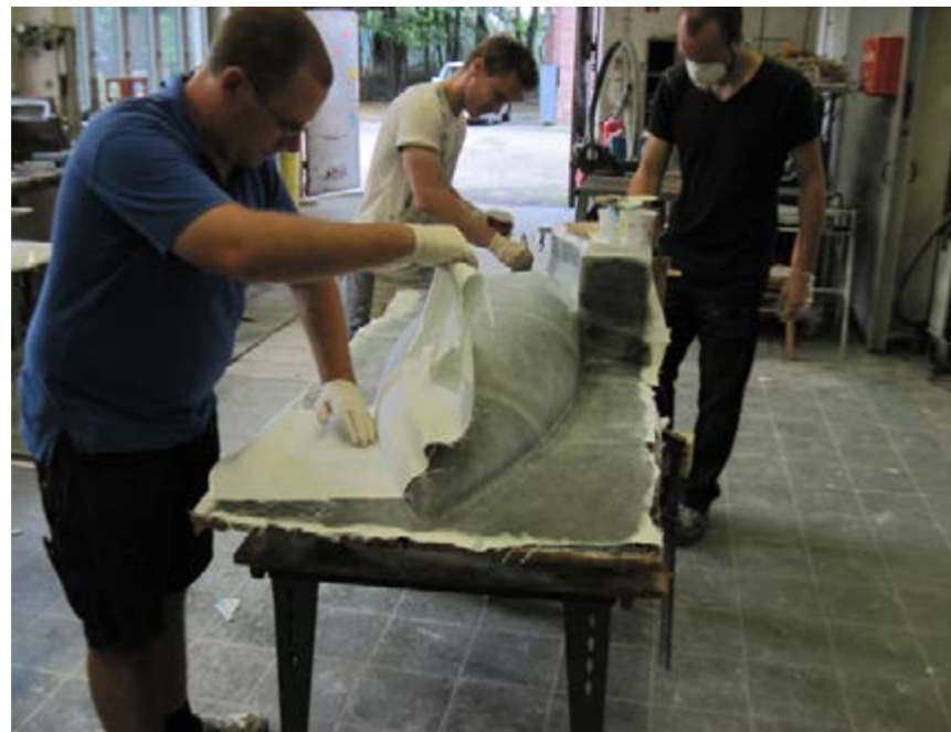
Rückseite mit Epoxidharz und Carbon/Glas verstärken
