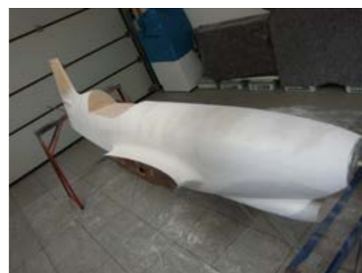
Das Modell nachdem es geschliffen und für die Abformung vorbereitet wurde.
