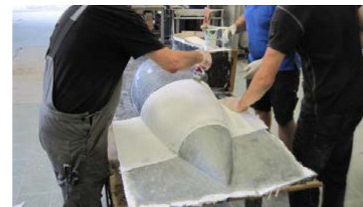
Rückseite mit Epoxidharz und Carbon/Glas verstärken
