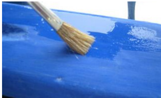
Abb. 4: Auftragen des Folientrennmittels
