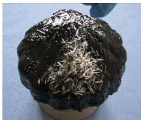
Abb. 9: Aufstreuen von Glasfaserschnitzeln
