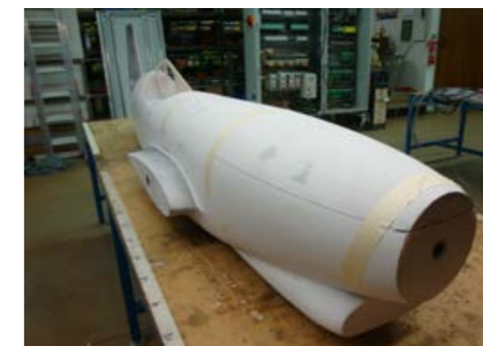
Das Modell nachdem es geschliffen und für die Abformung vorbereitet wurde.
