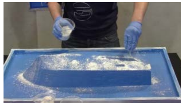
Aufstreuen der Trockenkupplungsschicht (Glasfaserschnitzel und Baumwollflocken)
