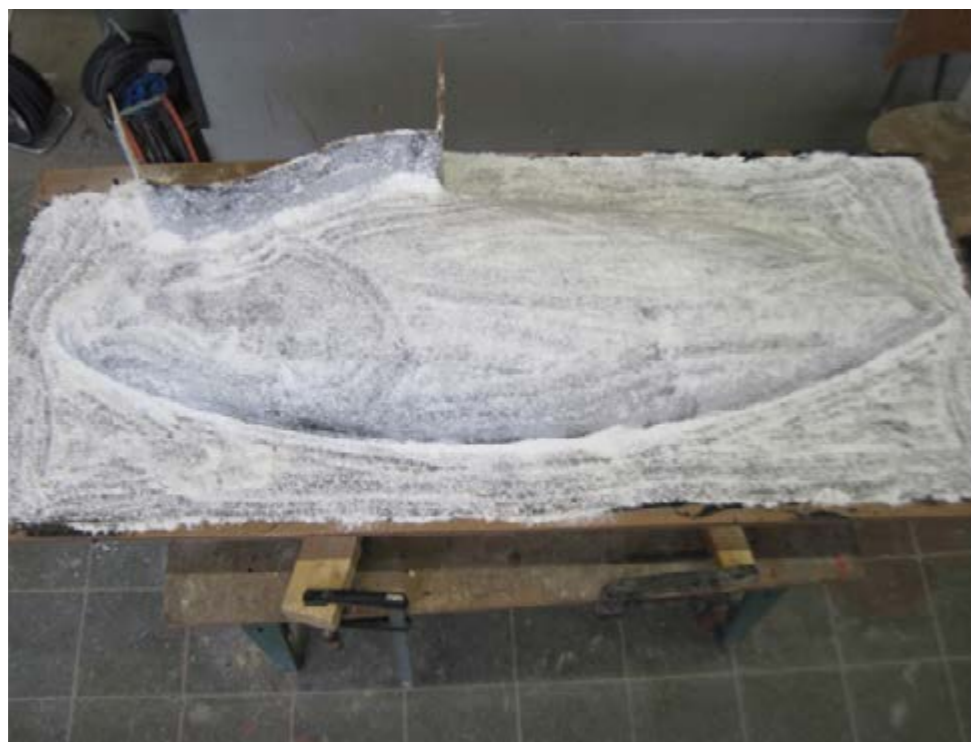
Trockenkupplungsschicht aus Baumwollflocken & Glasfaserschnitzeln
