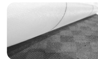
2. Vor der Weiterverarbeitung im spitzen Winkel abreißen
