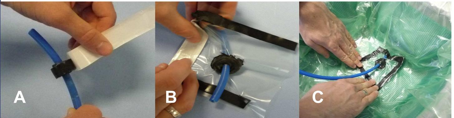
Abb. 29, A-C: Anschluss der Leitung zur Harzinfusion.
