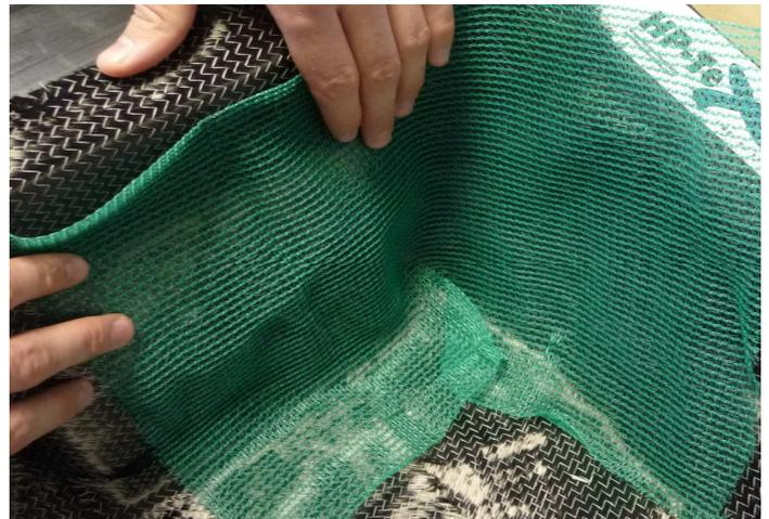
Abb. 25: Fließhilfe (nur für Vakuuminfusion).
