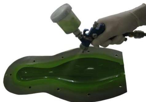
Abb. 33: Das In-Mould Coating **HP-IMC** wird in eine eingetrennte Form lackiert.
