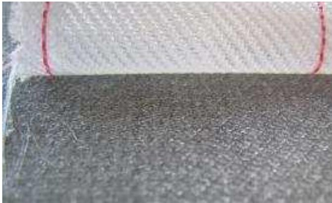
Abb.24: ...nach dem Aushärten entsprechendes Entfernen des Abreißgewebes.
