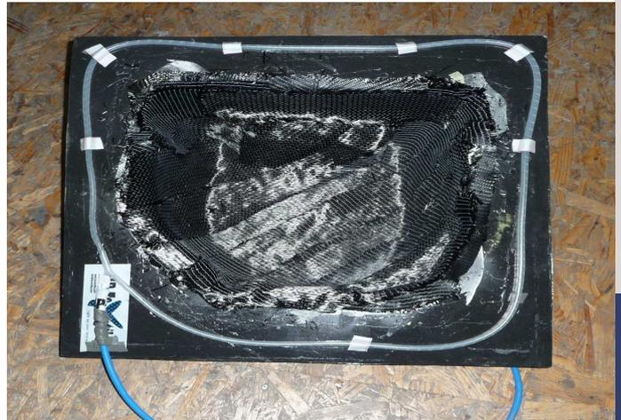
Abb. 26: Die Spiralleitung am Beuteilrand.
