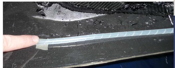
Abb. 15: Die mit Vakuum-Dichtband fixierte Spiralleitung am Formenrand.
